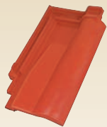
dachówka wentylacyjna (wentylacyjnej wynosi 25 cm 2 , zapotrzebowanie ok. 20 szt./100 m 2 )
