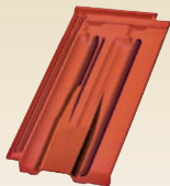
dachówka wentylacyjna (wentylacyjnej wynosi 25 cm 2 , zapotrzebowanie ok. 20 szt./100 m 2 )
