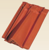
dachówka wentylacyjna (wentylacyjnej wynosi 18 cm 2 , zapotrzebowanie ok. 28 szt./100 m 2 )
