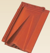
dachówka wentylacyjna (wentylacyjnej wynosi 18 cm 2 , zapotrzebowanie ok. 28 szt./100 m 2 )
