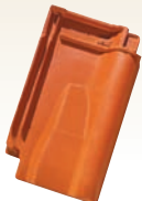
dachówka wentylacyjna (wentylacyjnej wynosi 25 cm 2 , zapotrzebowanie ok. 20 szt./100 m 2 )
